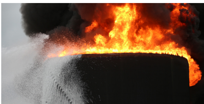
Versuch Bekämpfung Tankbrand mit F3-Schaummittel over-the-top mit Werfer
