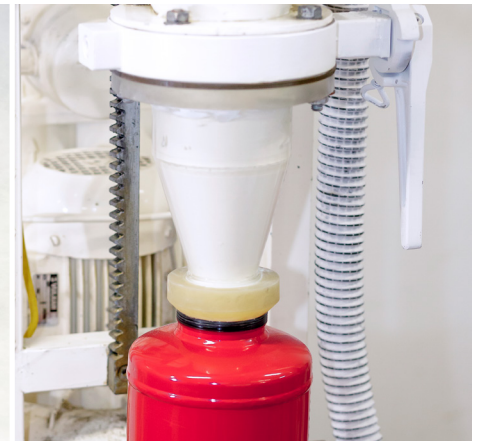
6 Befüllung des Löschmittelbehälters 4 Min
