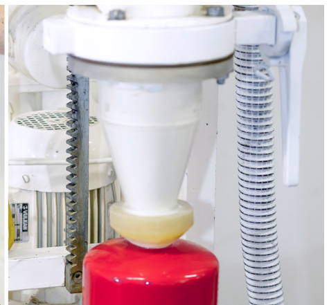
6 Befüllung des Löschmittelbehälters 4 Min
